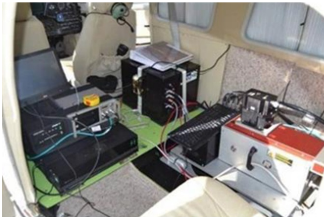
Figura 4 - Detalhes do Sistema SAAP embarcado em aeronave da Engemap.
